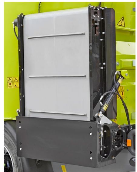
Disponibili prolunghe di scarico di varie lunghezze Unloading extensions with different lengths available Disponibles extensiones de descarga de varias medidas
