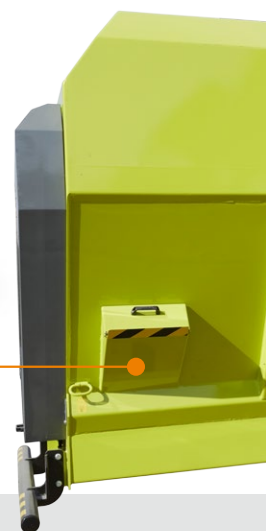
Tramoggia farine sul cassone standard Standard concentrates loading trap in the tank Tolva para concentrados en la cuba standard
