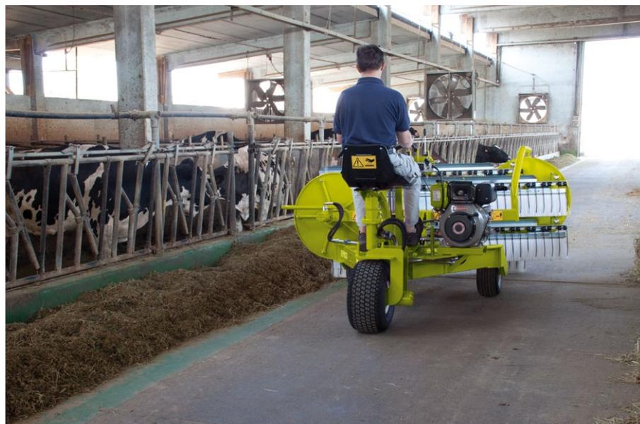
La motospazzola è equipaggiata di idroguida con sistema "Load Sensing". Questo sistema, e la possibilità della ruota posteriore di ruotare di 90° in entrambi i sensi, permettono alla macchina di girare su se stessa con un raggio di solo 1.70 m.
