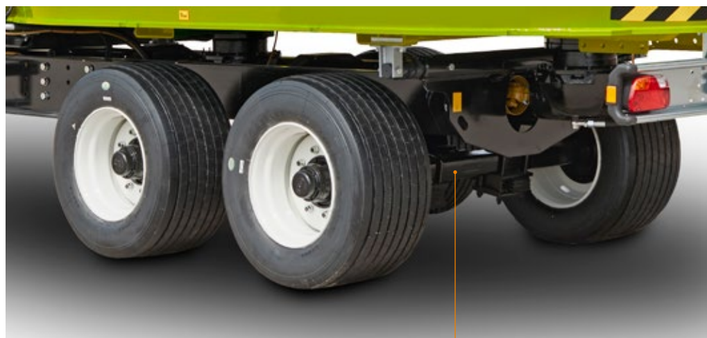
Nuovo bogie balestrato, disponibile in versione fissa ed autosterzante sia sui dunker T25 che T2L New sprung bogie, available also in self-steering version, both on dunker T25 and T2L Nuevo bogie con suspensiones, también en versión autoguiada, disponible en el dunker T25 y T2L
