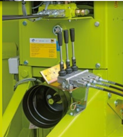
Due tipologie di comandi: elettrici (a sinistra) e meccanici flessibili al trattore (a destra)
