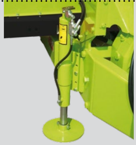
Piede di appoggio a comando oleodinamico collegato all'impianto idraulico del carro miscelatore Hydraulic foot connected to mixer wagon hydraulics and controls Pie de apoyo hidráulico conectado a la instalación hidráulica del carro mezclador
