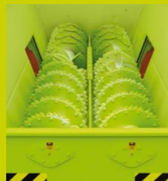
Die höhenverstellbare Gegenschneide zwischen den beiden Schnecken garantiert einen schnellen, präzisen Schnitt ohne Ausfaserungen. In kurzer Zeit wird ein ganzer Ballen geschnitten.
