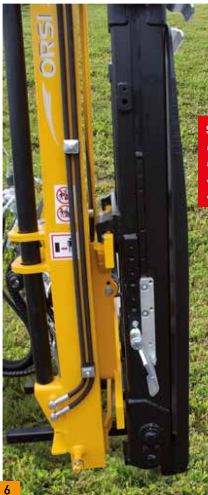
FORCHE IN ACCIAIO CON CHIUSURA IDRAULICA AUTOMATICA PRINTED STEEL FORKS WITH AUTOMATIC HYDRAULIC CLOSING HUBGABELN AUS GEPRESSTEN STAHL MIT AUTOMATISCHER UND HYDRAULISCHER SCHLIESSUNG FOURCHES EN ACIER AVEC FERMETURE HYDRAULIQUE ET AUTOMATIQUE HORCAS EN ACERO IMPRESO CON CIERRE HIDRAULICO AUTOMATICO
