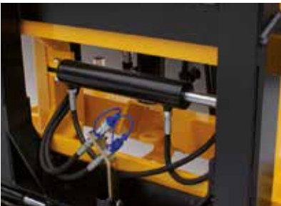
PATTINI IN ARNITE ANTIUSURA E AUTOLUBRIFICANTI SLIDING COILS IN SPECIAL MATERIAL AGAINST USURY AND SELF-LUBRICATING GLEITPROFIL AUS HALTBARER UND SELBSTÖLENDER ARNITQUALITÄT PATINS TRANSLATEUR EN MATÉRIEL SPÉCIAL AUTOLUBRIFIANT ET ANTI-USURE PATINES EN ARNITE ANTIDESGASTE Y AUTOLUBRICANTE
