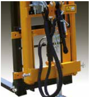
I TUBI LUNGHII PERMETTONO AL DISTRIBUTORE DI ESSERE SPOSTATO THE DISTRIBUTOR CAN BE MOUVED THANKS TO LONGER PIPES DANK ZU LANGEN SCHLAUCHEN, KANN MAN DIE STEUERUNG BEWEGEN LES TUYAUX LONG PERMETTENT AU DISTRIBUTEUR D'ETRE DEPLACÉ TUBOS LARGOS PERMITEN AL DISTRIBUIDOR DE SER DESPLAZADO
