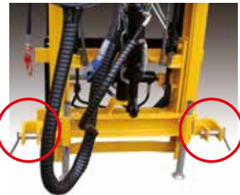
OHT / OHT GV 15 (4M) STRINGICARICO LOADING BLOCK HYDR. KISTENHALTER PRESSEUR DE CHARGE APRETON DE CARGA ATTACCO AL TRATTORE CAT II 3RD POINT LINKAGE CAT II DREIPUNKTANBAU KAT II ATTELAGE 3E POINT CAT II CONEXION AL TRACTOR CAT II
