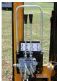
OHS 10 (1-2-3M) DISTRIBUTORE PREDISPOSTO AD ULTERIORE MOVIMENTO (IR)
